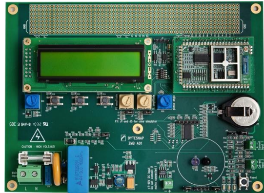
ZDM-01 with ZMM-01 module installed
