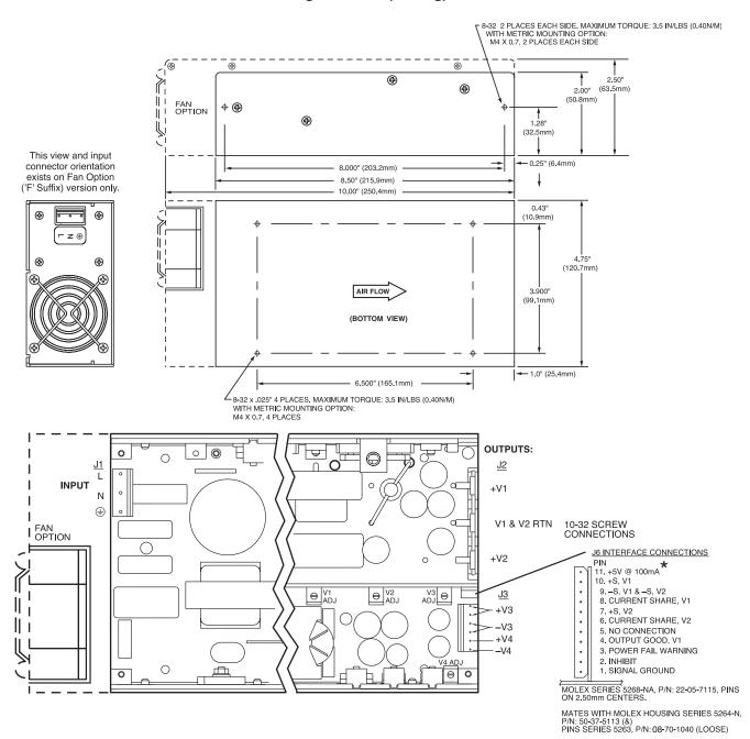
MOLEX SERIES PIN SERIES PINS (LOOSE) PINS (CHAIN) WIRE GAUGE CONNECTOR HOUSING 41695 09-50-8051 6838 08-50-0189 08-50-0187 18-20AWG 2478 2478 6838 2478 J1 41695 09-50-8051 08-50-0106 08-50-0105 18-20AWG 08-50-0105 08-50-0187 08-50-0105 2139 41695 09-50-3051 08-50-0106 18-20AWG 08-50-0189 08-50-0106 18-20AWG 18-20AWG 09-50-8061 09-50-8061 41695 J3 09-50-3061 2478 2139 08-50-0106 08-50-0105 18-20AWG J6 5264-N 50-37-5113 08-70-1040 08-70-1039
