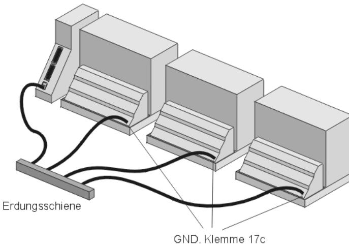
Erdungsschiene nach Möglichkeit mit Schaltschrank-Erdungsschiene verbinden!
